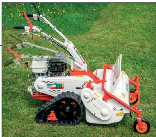
Orec HRC 802 s motorem Honda o výkone 9,5 k váží 190 kg. Pro dobrou prostupnost těžkým terénem je vybavený pásy ovládanými s pomocí pák na výškově i stranově nastavitelných klečích (řídítkách). Cepákové žací ústrojí se šířkou záběru 80 cm je osazené noži ve tvaru upsilon. Mechanická převodovka poskytuje tři rychlosti vpřed a jednu vzad
