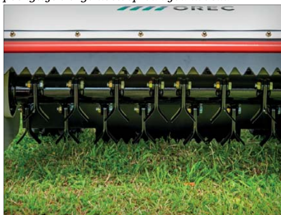
Orec HRC 802 s motorem Honda o výkone 9,5 k váží 190 kg. Pro dobrou prostupnost těžkým terénem je vybavený pásy ovládanými s pomocí pák na výškově i stranově nastavitelných klečích (řídítkách). Cepákové žací ústrojí se šířkou záběru 80 cm je osazené noži ve tvaru upsilon. Mechanická převodovka poskytuje tři rychlosti vpřed a jednu vzad
