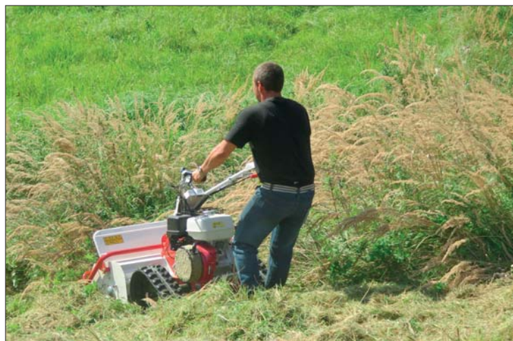
Ručně vedený profesionální cepový mulčovač Orec HRC 802 na pásovém podvozku lze využít pro extenzivní údržbu zeleně a odstraňování náletových dřevin na rovině i ve svazitém terénu
