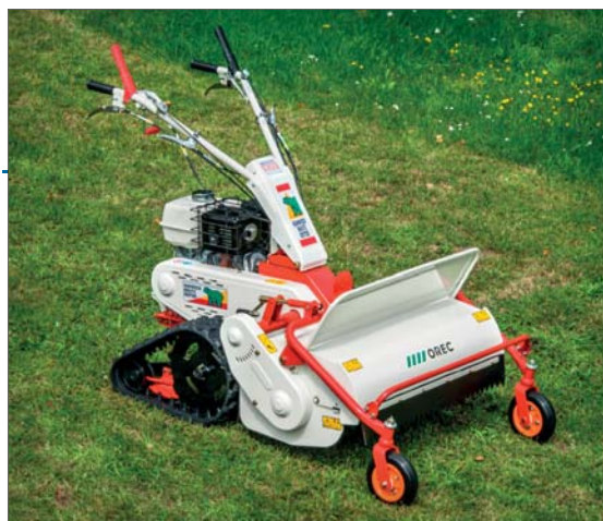
Orec HRC 802 s motorem Honda o výkone 9,5 k váží 190 kg. Pro dobrou prostupnost těžkým terénem je vybavený pásy ovládanými s pomocí pák na výškově i stranově nastavitelných klečích (řídítkách). Cepákové žací ústrojí se šířkou záběru 80 cm je osazené noži ve tvaru upsilon. Mechanická převodovka poskytuje tři rychlosti vpřed a jednu vzad
