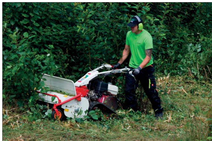
Ručně vedený profesionální cepový mulčovač Orec HRC 802 na pásovém podvozku lze využít pro extenzivní údržbu zeleně a odstraňování náletových dřevin na rovině i ve svazitém terénu
